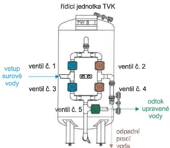
Nastavení pneumatických membránových ventilů:
